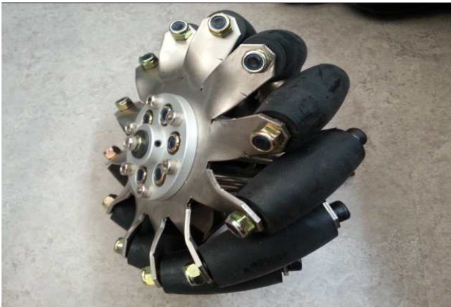
그림 110 전후좌우 움직임이 가능한 메카넘 휠
