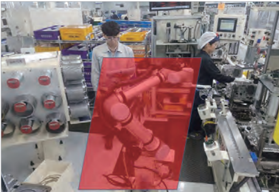
(d) 위험구역 내 조작 펜던트는 안전한 구역으로 위치를 변경하여 보관하였다.
