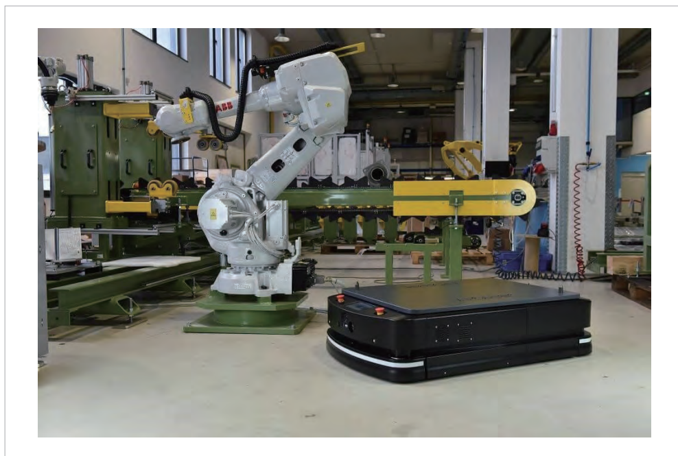
그림 2-3 AGV 기반의 FMS 시스템의 예 [3]
