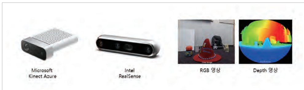
그림 10-3 카메라와 라이다를 결합한 센서와 영상 ( https://www.microsoft.com , https://www.intel.com )
