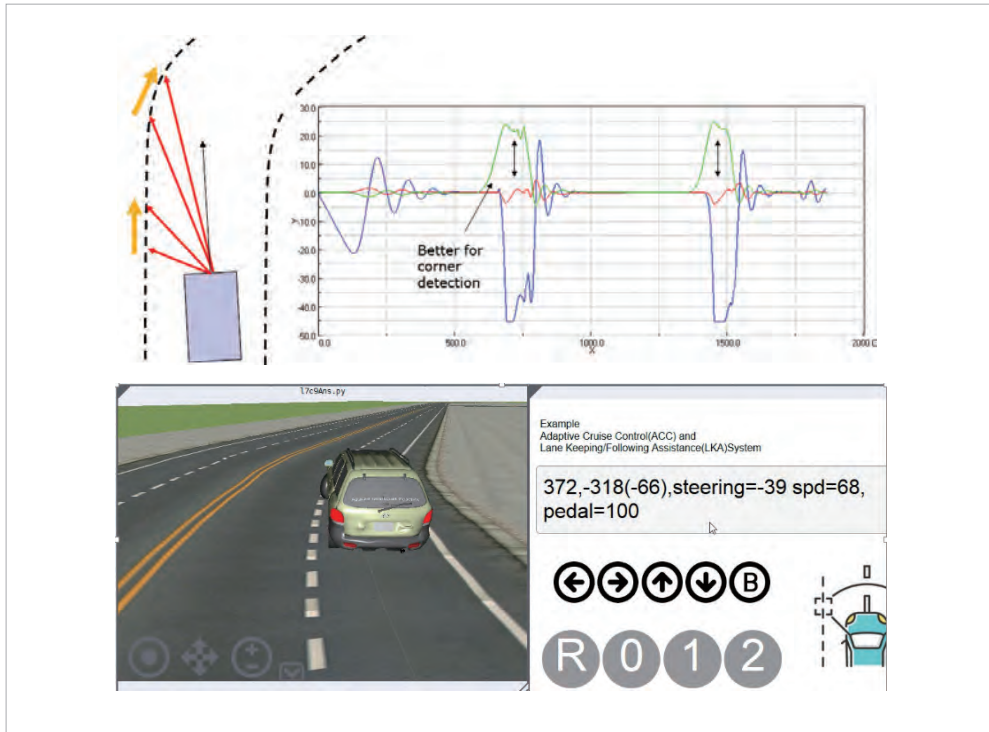
그림 12-15 전방 차선과 차량 주변 차선과의 각도 차이를 통한 코너 진입 감지
