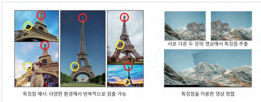
그림 10-4 특징 검출과 데이터 정합 (M. Brown and D. G. Lowe. Automatic Panoramic Image Stitching using Invariant Features, IJCV, 2007)
