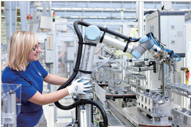
그림 11-1 2013년 세계 최초로 대량생산 공정(독일 V사)에 설치된 협동 로봇 UR ( https://blog.robotiq.com/bid/71494/Universal-Robots-Release-their-New-Generation-of-Collaborative-Robots )
