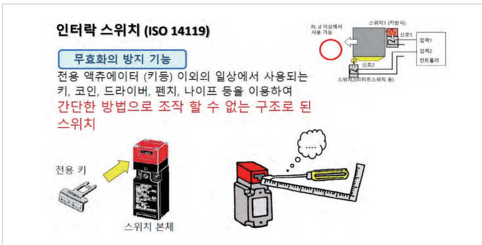
그림 9-7 인터락 스위치 설치 사례
